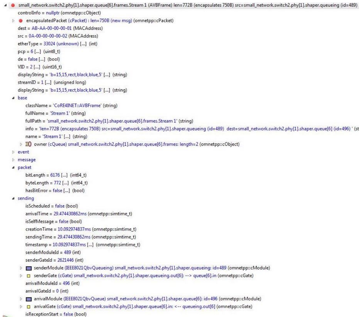
Figura 2.7: Captura de pantalla sobre los detalles que provee el simulador sobre un mensaje transmitido durante una de las simulaciones. El mensaje es una trama de tipo AVB de clase B y fue recibido por el switch 2 en la topología Cadena. Entre otros datos, puede observarse la dirección MAC de origen como la de destino, la prioridad PCP, el vlan ID, el número de Stream al que pertenece el mensaje (en este caso 1). Esta trama en el momento de la captura se encuentra en la cola número 6 del algoritmo de selección de tráfico del puerto 1 del switch.
